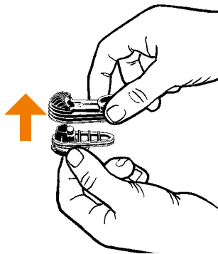
Retrait du Couvercle de la Base de l'Unité de Refroidissement
