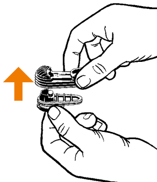
Kühleinheitdeckel vom Kühleinheitboden abziehen
