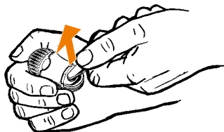
Herausziehen des Mundstücks aus dem Kühleinheitdeckel
