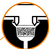
Cámara de Relleno correctamente llena
