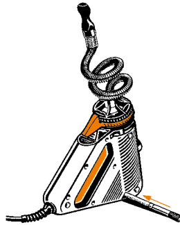
PLENTY Heißluftzeuger aufstellen
