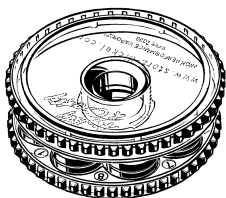
Colocación de la tapa del Depósito
