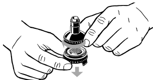
Enrosca la Tapa del Depósito
