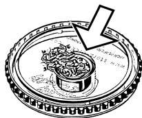
Dosierkapsel beim Befüllen mit Magazindeckel (Trichter)
