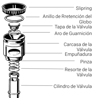
Desmontar la Pieza Interior del Depósito
