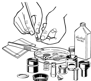
Nettoyage manuel avec de l'alcool isopropylique (70 %) ou un produit vaisselle
