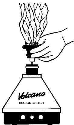
Unir el Globo de Válvula con la Cámara de Relleno
