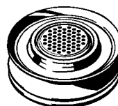
Die in den Füllkammerreduzierer eingesetzte Dosierkapsel
