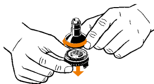
Enrosca la Tapa de Cámara de Relleno
