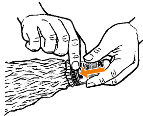
Den Ballon mit dem Slipring fixieren
