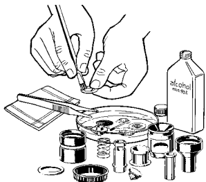
Nettoyage manuel à l'alcool (min. 90%)
