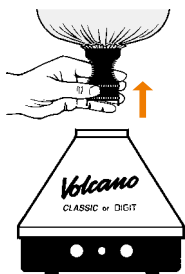
Quitar el Globo de Válvula con la Cámara de Relleno
