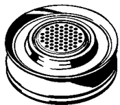
La Cápsula Monodosis incrustada en el Reductor de Cámara de Relleno
