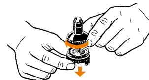
Avvitare il Coperchio della Camera di Riempimento
