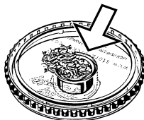
Capsula dosatrice durante il riempimento con coperchio del Caricatore (imbuto)
