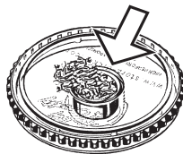
Dosierkapsel beim Befüllen mit Magazineckel (Trichter)
