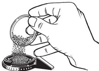
Füllkammer immer vollständig bis zum oberen Rand befüllen
