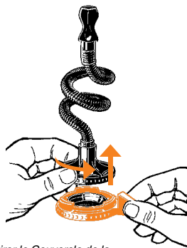
Retirer le Couvercle de la Chambre de Remplissage avec la Spirale de Refroidissement
