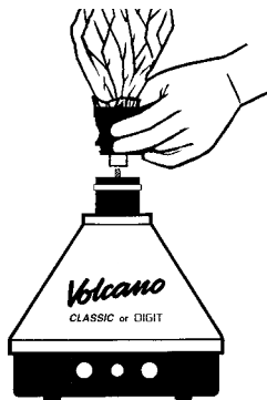
Relier le Ballon à Valve sur la Chambre de Remplissage
