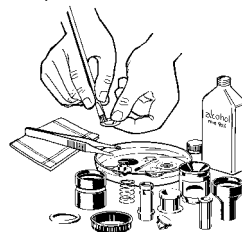
Nettoyage manuel à l'alcool (min. 90%)
