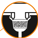
Chambre de Remplissage correctement remplie
