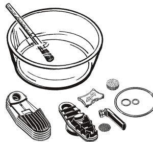
Nettoyage manuel de l'Unité de Refroidissement démontée
